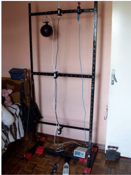
Figura 3.4 – Suporte metálico com sensores anexados
